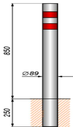
Рис. 4. Внешний вид и размеры столбика ограждения
